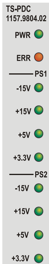
Bild 4-4: LEDs am Modul R&S TS-PDC ab Version 2.0
